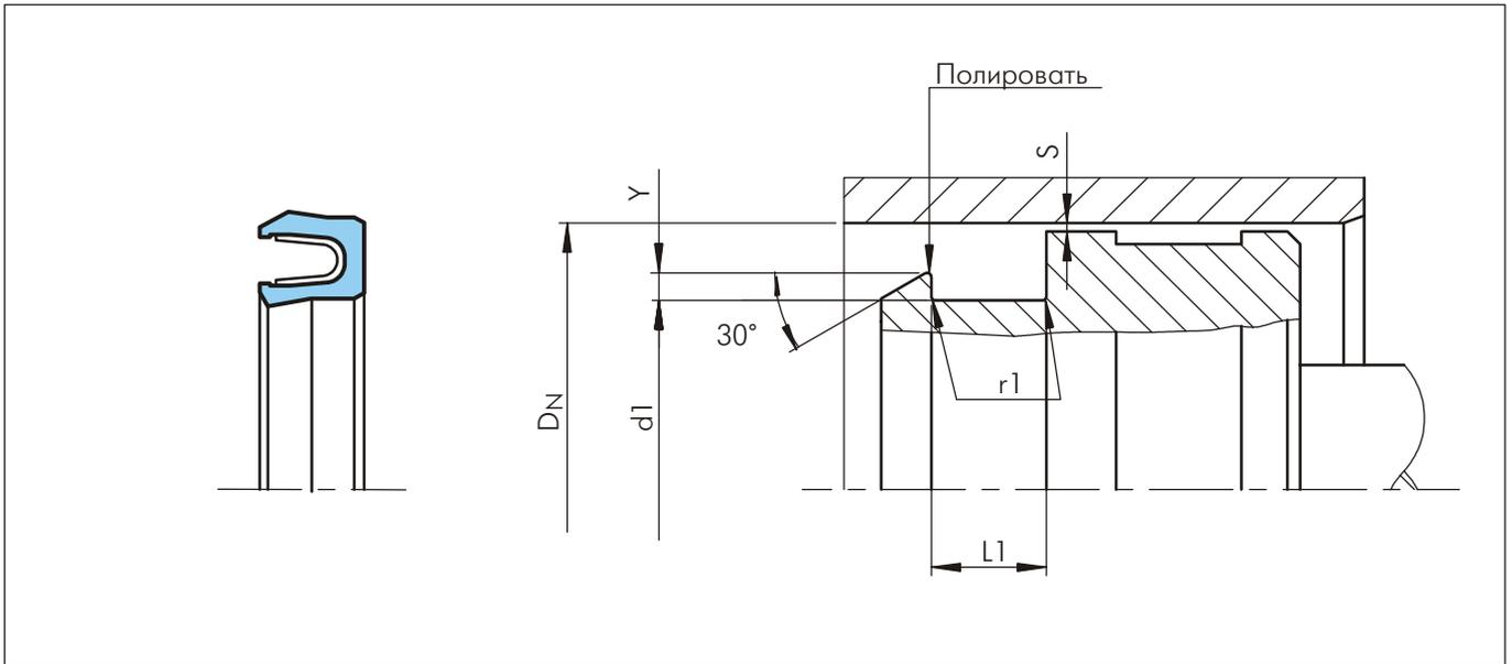
Рисунок 32 Схема монтажа
