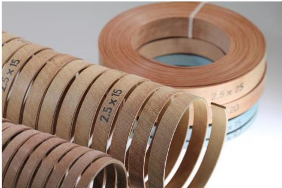
Материал Krutex 550T является аналогом известных фенольных композитов на тканевой основе типа Poluras 102, TSS C380 или Hallite 506. Для изготовления небольших партий колец мы можем предложить вариант исполнения в виде спиральной полосы некоторых размеров. В отличие от ленты из данного материала из спиральной полосы возможно изготовление колец диаметром менее 150 мм.
